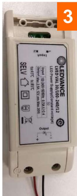
Conectar los cables de red eléctrica en "Input"
