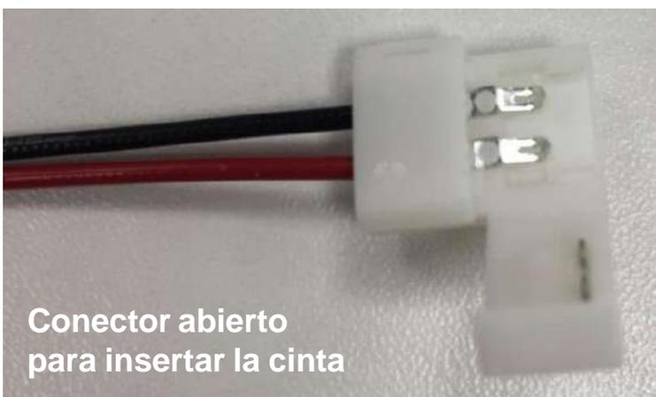
**Paso 2:** Remover la cinta adhesiva de extremo de cinta y conectar los terminales conforme indicado (+ con + y - con -)
